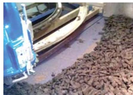
**Les fientes de volailles** sont tant sous une forme sèche qu'en granulés un excellent et populaire nutritif pour les plantes. Les sécheurs Dorset sont fréquemment utilisés pour le séchage des fientes à l'aide de l'air du poulailler. Dans la plupart des installations, il n'y a pas de pré-séchage. Ceci permet de réaliser des économies importantes sur les frais d'électricité.
