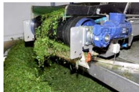
**Le séchage de lisier liquide ou de digestat** peut être utilisé sans séparation à partir de 8% de matières sèches, pour ceci, toute l'énergie disponible peut être utilisée et le produit obtenu est un nutritif valorisé pour les plantes.
