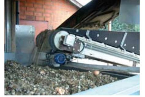
توضع الفضلات بشكل مرطوب على جهاز التجفيف و لا توجد أية عملية تجفيف مسبوق و تنقل الفضلات عبر هذه الأشرطة فحسب و عدم تنفيذ عملية التجفيف المسبوق يؤدي إلى الاقتصاد في تكاليف الكهرباء.
