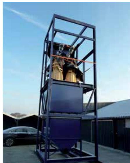
contenere più germi. Dorset progetta e consegna sistemi di essiccazione comprensivi di pellettizzazione ed insaccatura. La pellettizzazione è il processo attraverso cui il materiale viene condensato grazie a un'operazione di pressatura. I vantaggi sono riduzione di volume, trasportabilità e commerciabilità.
