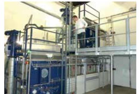
Für größere Anlagen sind doppelstöckige oder sogar vier- oder mehrstöckige Trocknungsanlagen verfügbar. Die Rückmischungstrockner sind auch einsetzbar für Getreide oder Körnermais.
