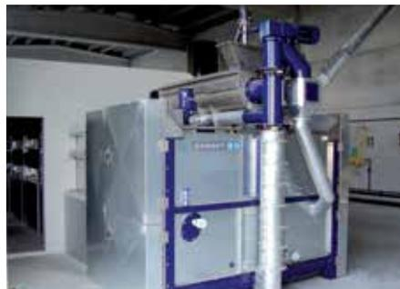
Das Rückmischverfahren ist eine hervorragende Möglichkeit, hochwertigen und transportfähigen Dünger herzustellen. Das Foto zeigt einen Bandtrockner mit Trocknerkopf, Pendelmischer und -verteiler.
