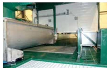
**Der TOMO-Containertrockner für Gärrest mit Rückmischung**
