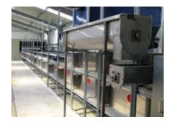
La Technique de séchage Dorset est utilisée pour le séchage de digestat ou de lisier de porc combiné à un laveur d'air trois étapes Combi. Ce laveur est spécialement étudié pour cette application et est livré en solution conteneurisée avec compartiment pompes et commande intégrée.
