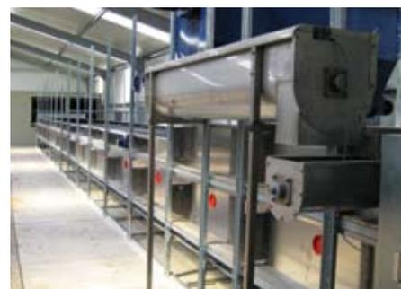
**La Technique de séchage Dorset** est utilisée pour le séchage de digestat ou de lisier de porc combiné à un laveur d'air trois étapes Combi. Ce laveur est spécialement étudié pour cette application et est livré en solution conteneurisée avec compartiment pompes et commande intégrée.
